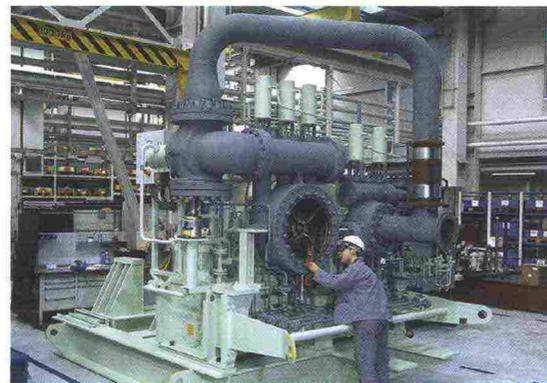
Affidabilità, flessibilità, tempi rapidi di commissioning e avviamento, minima manutenzione: in poche parole una turbina a vapore Howden. Le applicazioni di queste macchine sono molteplici: si passa dalla generazione di energia elettrica per impianti a biomasse, cogenerazione, recupero termico fino all'azionamento meccanico di pompe, ventilatori e compressori per le più svariate applicazioni industriali.
