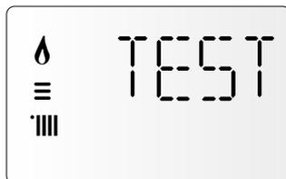
Ruotare l'encoder **4** per attivare la caldaia alla massima potenza sanitario.
