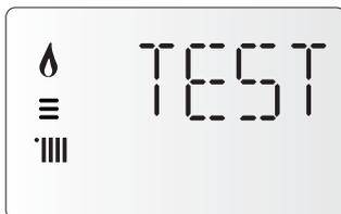
Ruotare l'encoder per attivare la caldaia alla massima potenza sanitario.
