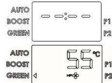
**Spegnimento:** per spegnere lo scaldacqua è sufficiente premere il tasto ON/OFF, rimane solo la scrittura “OFF” sul display. La protezione dalla corrosione continua ad essere assicurata e il prodotto provvederà automaticamente a non far scendere la temperatura dell’acqua nel serbatoio sotto i 5°C.
