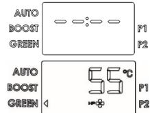
**Apagado:** para apagar el calentador de agua es suficiente presionar el botón ON/OFF. y permanece sólo la sigla “OFF” en el visor. La protección contra la corrosión sigue estando asegurada y el producto se encargará automáticamente de no permitir el descenso la temperatura del agua en el depósito por debajo de los 5°C.
