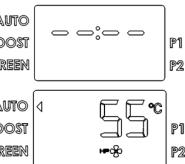
**Extinction:** pour éteindre le chauffe-eau, il suffit d'appuyer sur le bouton ON/OFF, il reste exclusivement l'indication "OFF" sur l'écran. La protection contre la corrosion reste assurée et l'appareil se met en mode hors-gel, la température de l'eau à l'intérieur de la cuve est maintenue au-dessus de 5°C.
