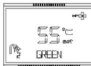
**Spegnimento:** per spegnere lo scaldacqua è sufficiente premere il tasto ON/OFF, rimane solo la scrittura "OFF" sul display. La protezione dalla corrosione continua ad essere assicurata (in caso di utilizzo del contatto HC-HP inserire batterie ricaricabili, vedere fig. 1 e cap. 5) e il prodotto provvederà automaticamente a non far scendere la temperatura dell'acqua nel serbatoio sotto i 5°C.
