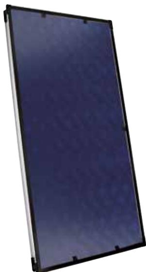
Collettore solare vetrato piano ad alto rendimento per circolazione forzata conforme alla norma EN 12975 e certificato Solar Keymark con superficie lorda pari a 2,52 m<sup>2</sup> (2240x1125x98 mm), superficie di apertura pari a 2,256 m<sup>2</sup>, superficie assorbente pari a 2,2 m<sup>2</sup> e peso di 46 Kg.
