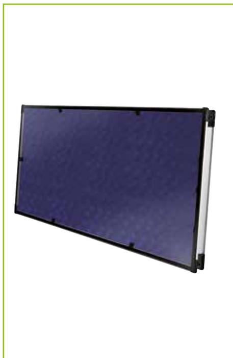
Collettore solare vetrato piano ad alto rendimento per circolazione forzata conforme alla norma EN 12975 e certificato Solar Keymark con superficie lorda pari a 2,52 m<sup>2</sup> (2240x1125x98 mm), superficie di apertura pari a 2,256 m<sup>2</sup>, superficie assorbente pari a 2,2 m<sup>2</sup> e peso di 46 Kg.
