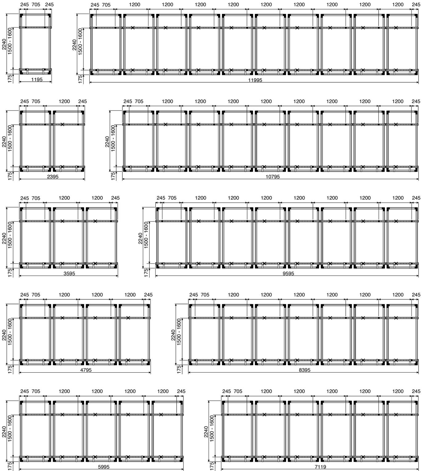
**A:** punti di fissaggio consigliati in condizioni di carichi normali ( 1.2KN/m<sup>2</sup> di neve, 28m/s vento - 100Km/h).
