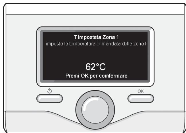
Modifica temperatura acqua calda riscaldamento
