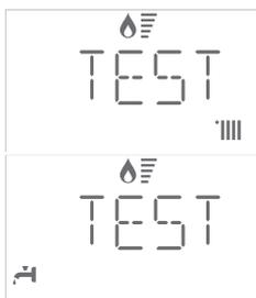
Ruotare l'encoder **(9)** per attivare la caldaia alla massima potenza sanitario.
