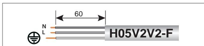
Controllare che la sezione dei cavi sia idonea, comunque non inferiore a  $0,75 \text{ mm}^2$ .
