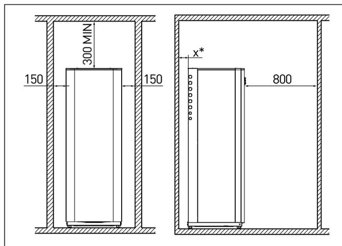
\*x = 0 mm con kit di collegamento idraulico a destra/sinistra
