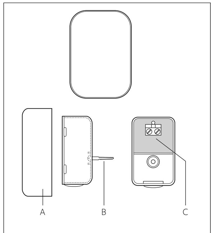
Posizionare la sonda esterna nella parete nord dell'edificio ad una altezza da terra non inferiore ai 2,5 m evitando l'esposizione diretta ai raggi solari.
