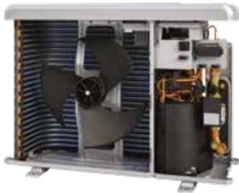
Tutta la gamma Hybrid Chaffoteaux è dotata di pompa di calore «Monoblocco». Significa che il gas refrigerante è contenuto nella sola unità esterna mentre le connessioni tra unità esterna ed interna sono completamente idroniche. L'installazione è semplice, senza intervento sul circuito frigorifero.
