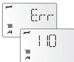
Non appena la causa dell'arresto scompare, la caldaia riparte e riprende il suo normale funzionamento. Se la caldaia segnalerà ancora l'arresto di sicurezza, spegnere la caldaia. Portare l'interruttore elettrico esterno in posizione OFF, chiudere il rubinetto del gas e contattare un tecnico qualificato.
