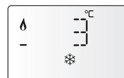
Se la sonda NTC di mandata è danneggiata, la funzione viene esplicita dalla sonda di ritorno. Il bruciatore non si accende e si attiva il circolatore, come sopra indicato, quando la temperatura misurata è < 8°C.
