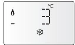
Se la sonda NTC di mandata è danneggiata, la funzione viene esplicata dalla sonda di ritorno. Il bruciatore non si accende e si attiva il circolatore, come sopra indicato, quando la temperatura misurata è < 8°C.
