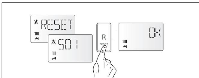
La prima cifra del codice di errore (Es: **1** 01) indica in quale gruppo funzionale della caldaia si è determinato l'errore:
