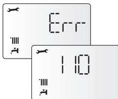
Non appena la causa dell'arresto scompare, la caldaia riparte e riprende il suo normale funzionamento. Se la caldaia segnalerà ancora l'arresto di sicurezza, spegnere la caldaia. Portare l'interruttore elettrico esterno in posizione OFF, chiudere il rubinetto del gas e contattare un tecnico qualificato.
