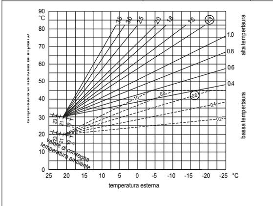
Nel caso di utilizzo della sonda esterna, la caldaia calcola la temperatura di mandata più idonea tenendo conto della temperatura all'esterno e del tipo di impianto.
