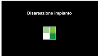
Durante il ciclo di disareazione aprire la valvola di sfogo manuale (2) sullo scambiatore di calore primario e richiuderla quando è visibile acqua priva da bolle d'aria.
