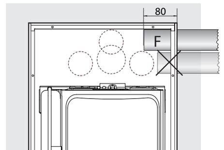
**Collegamento condotti sdoppiati (Ø80) con intubamento di Ø 50 o 60 mm.**
